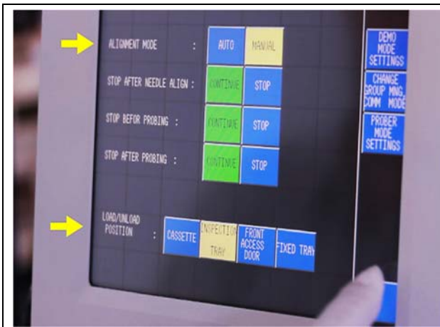
OPERATION SETTINGS ⇒ ALIGNMENT MODE ⇒ MANUAL ⇒ LOAD/UNLOAD POSITION ⇒ INSPECTION TRAY
